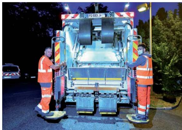
Certains points d'améliorations constatés durant le test ont été soit pris en compte par Renault Truck soit le seront ultérieurement : pompe hydraulique qui faisait du bruit, chauffage insuffisant, autonomie des batteries insuffisante pour certains parcours... On évalue aussi si l'on aurait besoin d'un klaxon supplémentaire, type bus, pour prévenir les piétons en milieu urbain dense ».
